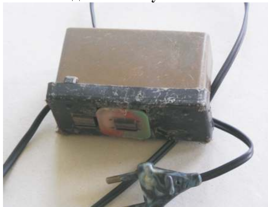
Размагничиватель, изготовленный из насоса для аквариума – в домашних условиях
