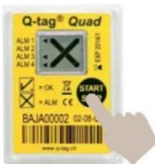
Q-tag® Quad может быть остановлен, по окончании транспортировки груза, (например, когда осуществлена поставка до конечного пункта назначения).
