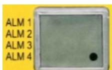
Устройство Q-tag® Quad поставляется в так называемом «Спящем режиме». Готовность к запуску и работоспособность устройства подтверждаются регулярно мигающей точкой на дисплее термоиндикатора.
